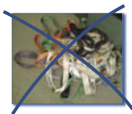
Verkeerde opslag van stropen.
